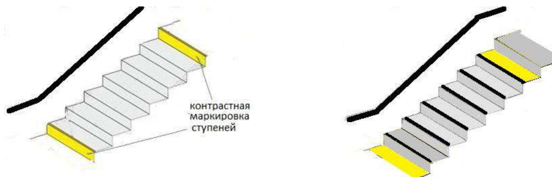
Рисунок 6.6.4 – Ошибки при контрастной маркировке ступеней
