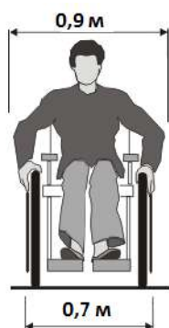
Ширина полосы движения человека в кресле-коляске
