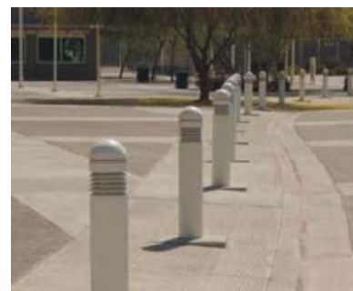
Рисунок 66 – Примеры ограждений, используемых в качестве направляющих устройств
