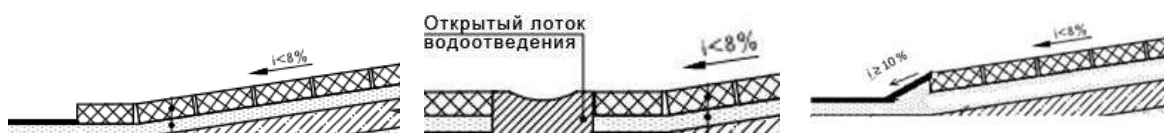
Рисунок 6.1.25 – Недопустимые неровности на границе наклонной части марша и горизонтальной площадки
