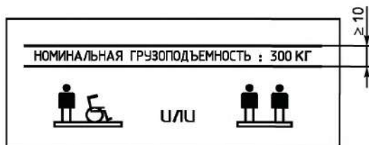
Рисунок 8 — Пример таблички с информацией о грузоподъемности
